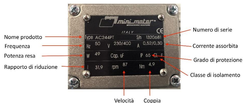
Figura 1 - Nomenclatura targa identificativa per motori/motoriduttori monofase, trifase e in corrente continua
